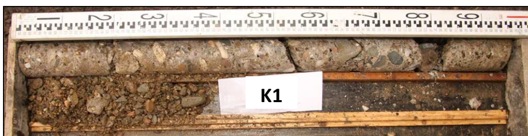
Obr. č. 3 - diagnostický vrt K1 - za rub klenby
