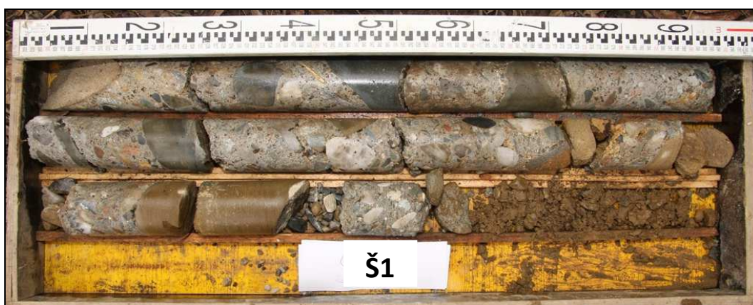
Obr. č. 2 - diagnostický vrt Š1 - pod úroveň základové spáry opěry Olomouc
